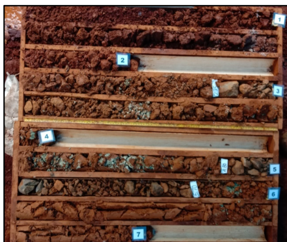
Gambar 2. Corebox zona overburden , limonit dan saprolit Block A
