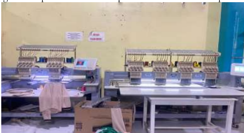
Gambar 2. Mesin Bordir Komputer Yang Digunakan Untuk Meningkatkan Kapasitas Dan Kualitas Produksi
