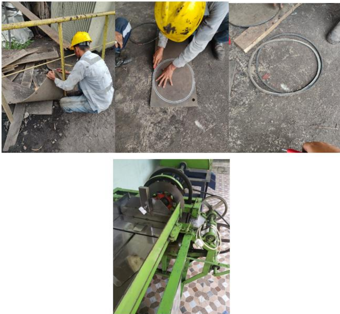
Gambar 6. Pemanfaatan Limbah Karet Belt Conveyor PTBA Untuk V-Belt Alat Pemotong Kerupuk
